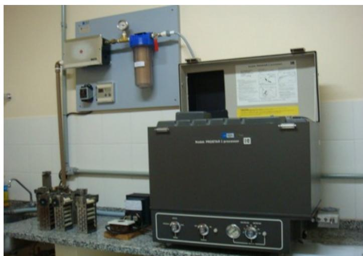
Figura 3: Processadora de microfilmes<sup>7</sup>
