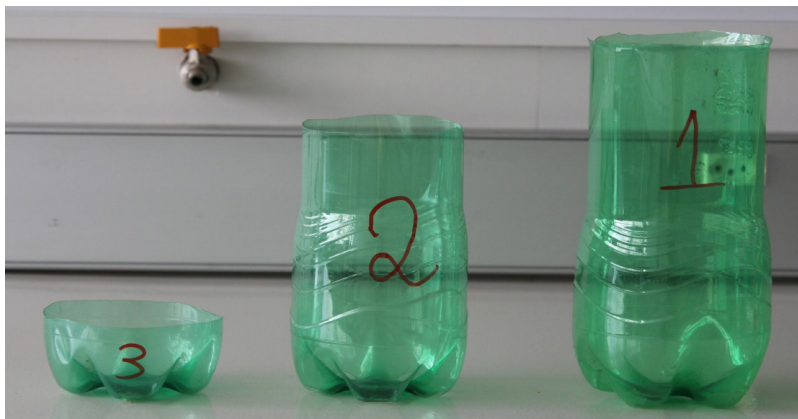
Figura 8 – Demonstração de como deve ser o recorte das garrafas Fonte: Elaborada pelos autores (2016)
